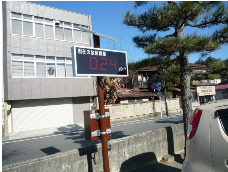
市役所駐車場に設置されたモニタリングポスト
